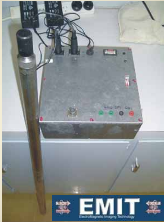
Down hole TEM probe
